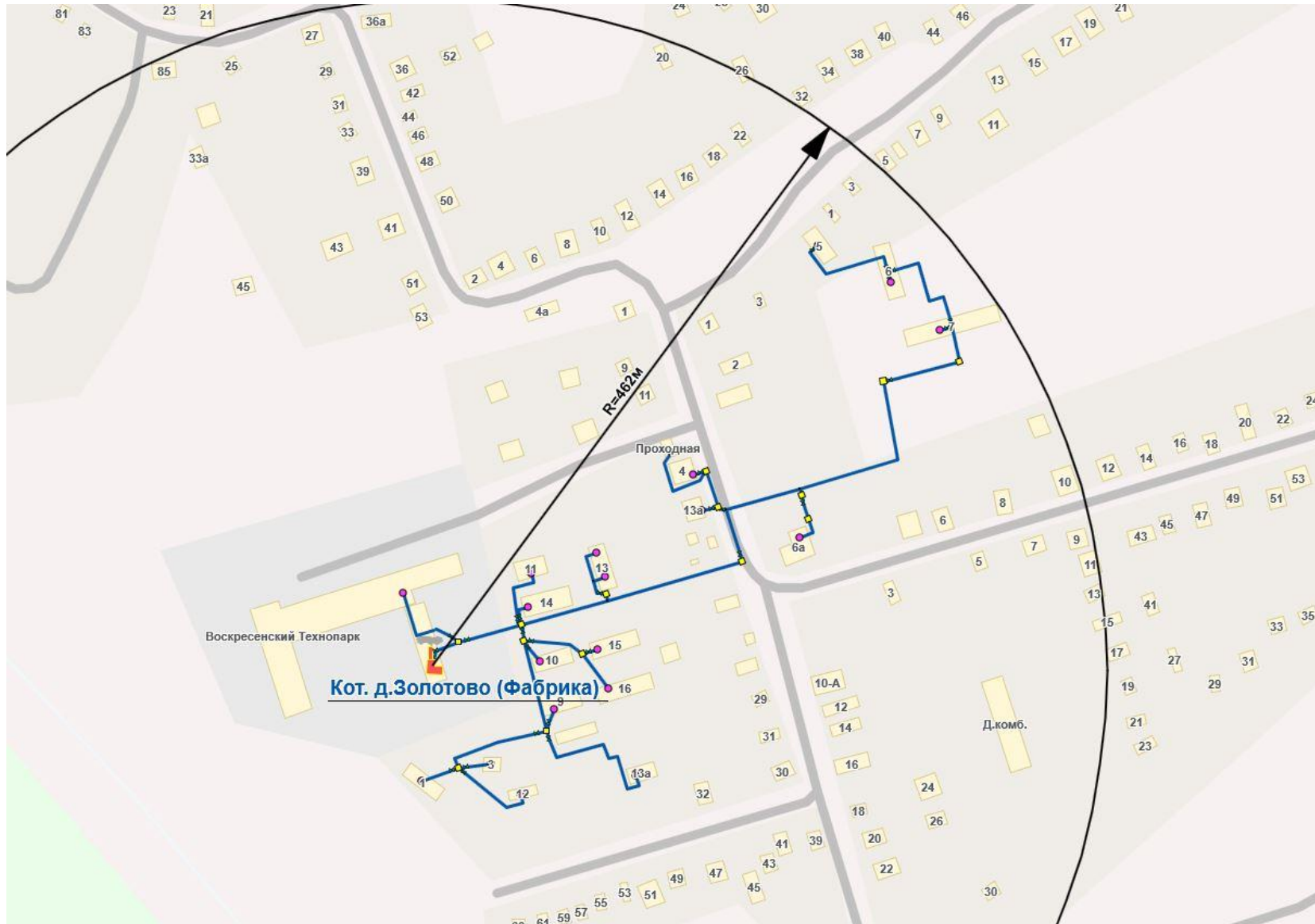
Рисунок 30 - Радиус эффективного теплоснабжения существующего источника тепловой энергии
