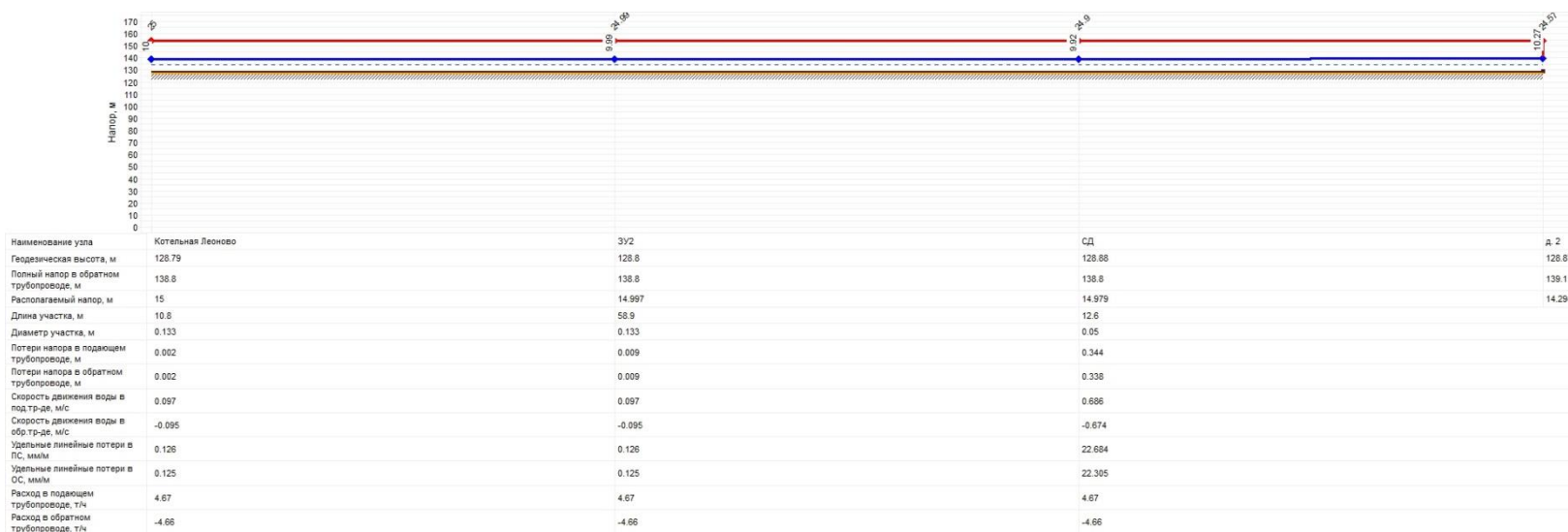
Рисунок 20 - Пьезометрический график от котельной д. Леоново до потребителя – жилой дом №2
