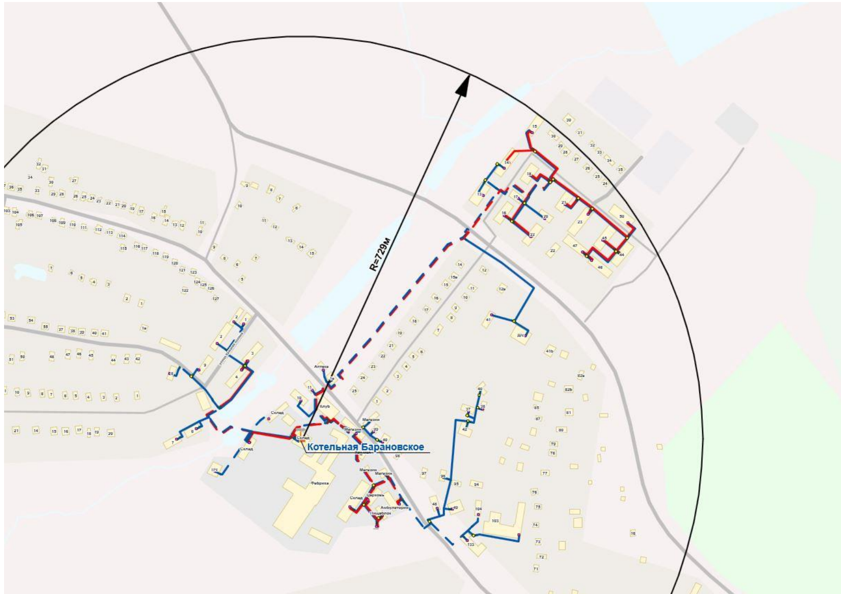
Рисунок 35 - Радиус эффективного теплоснабжения существующего источника тепловой энергии
