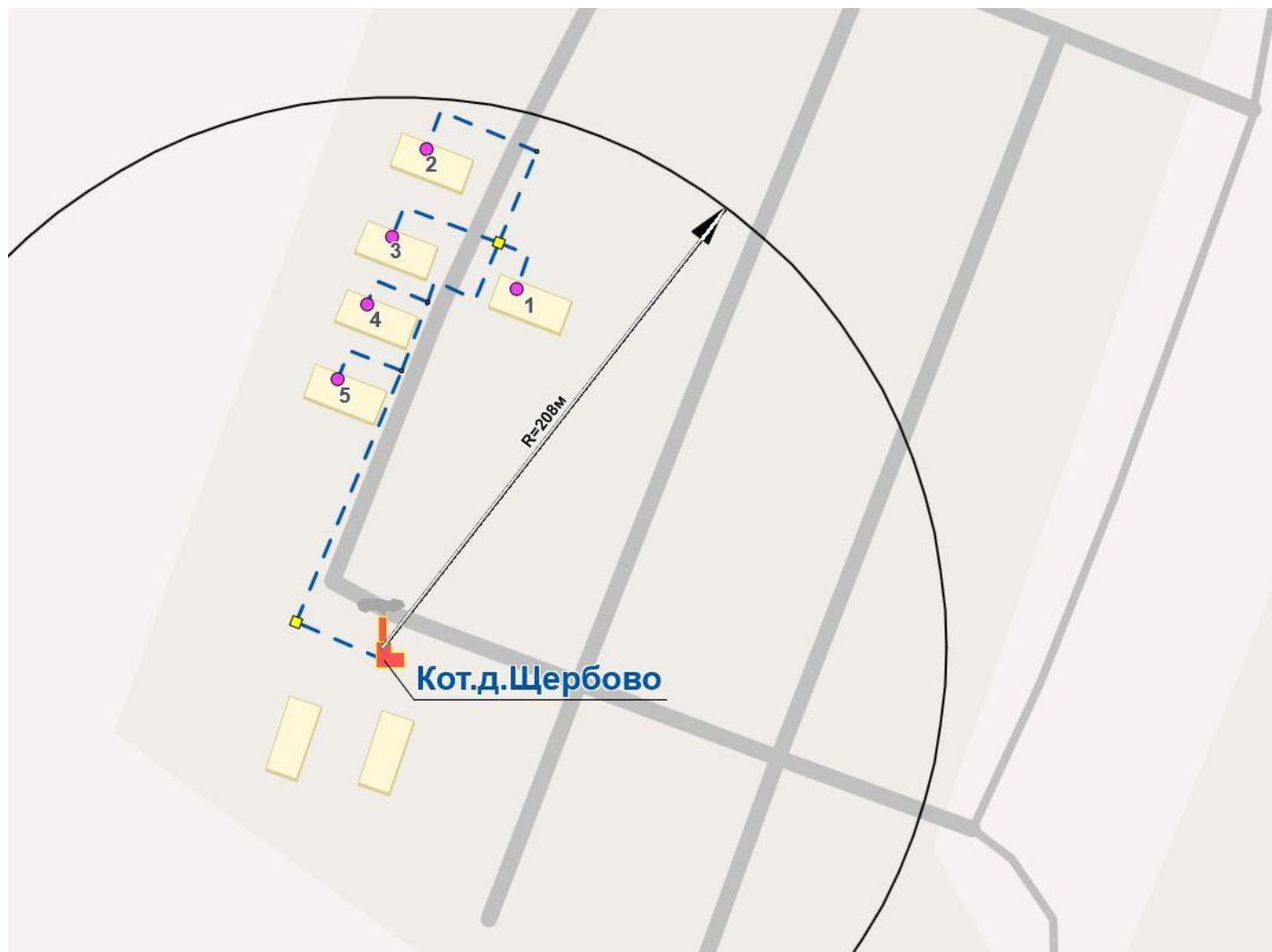
Рисунок 33 - Радиус эффективного теплоснабжения существующих источников тепловой энергии
