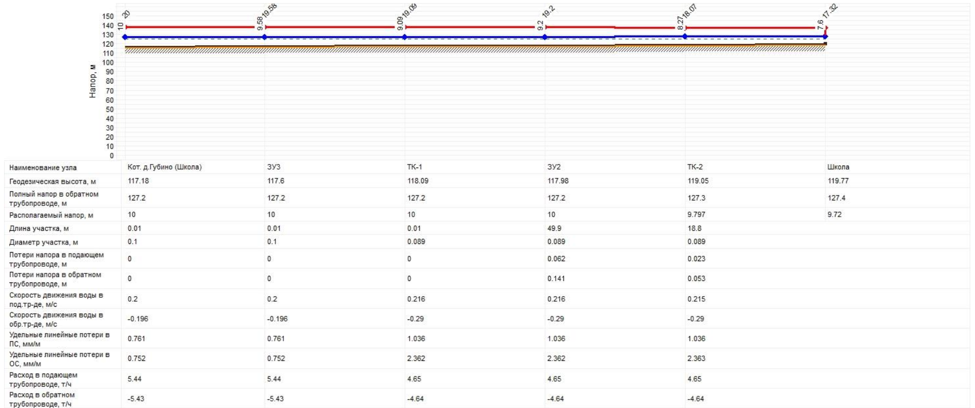
Рисунок 14 - Пьезометрический график от котельной д. Губино до потребителя - Школа
