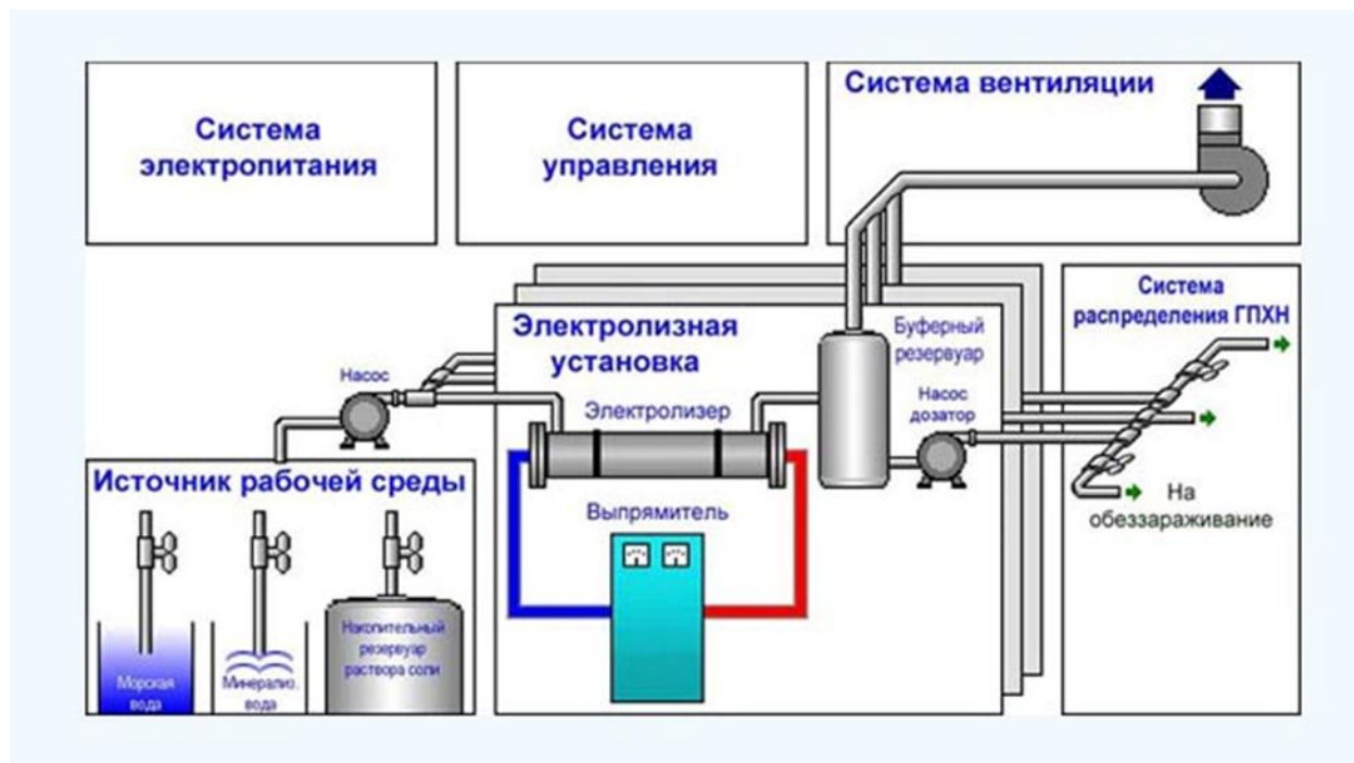
Рисунок 72 – Схема электролизной установки
