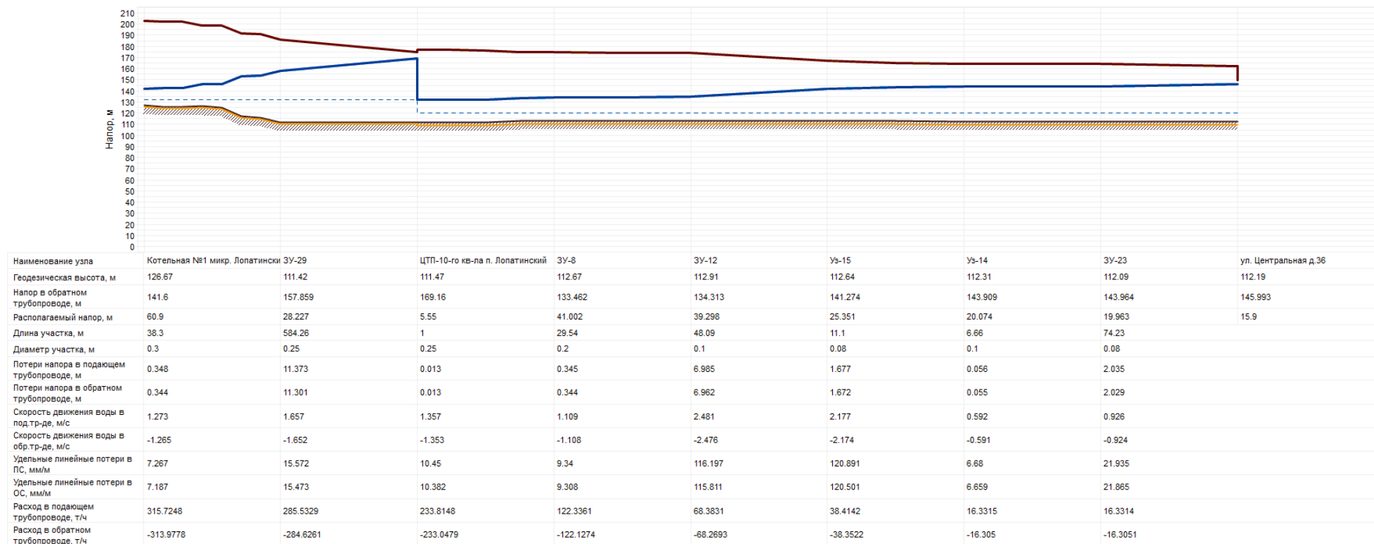
Рисунок П.7 – Пьезометрический график Котельной №1 микр. Лопатинский
