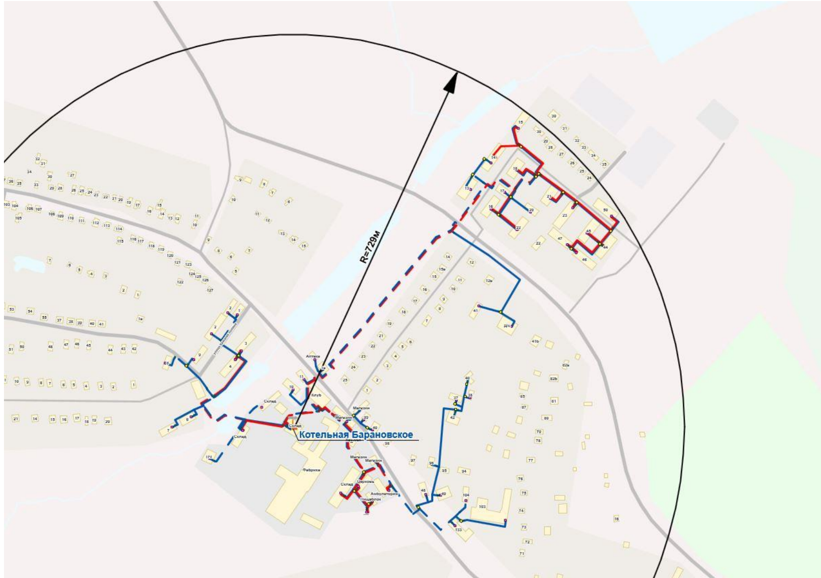
Рисунок 9 - Радиус эффективного теплоснабжения существующих источников тепловой энергии
