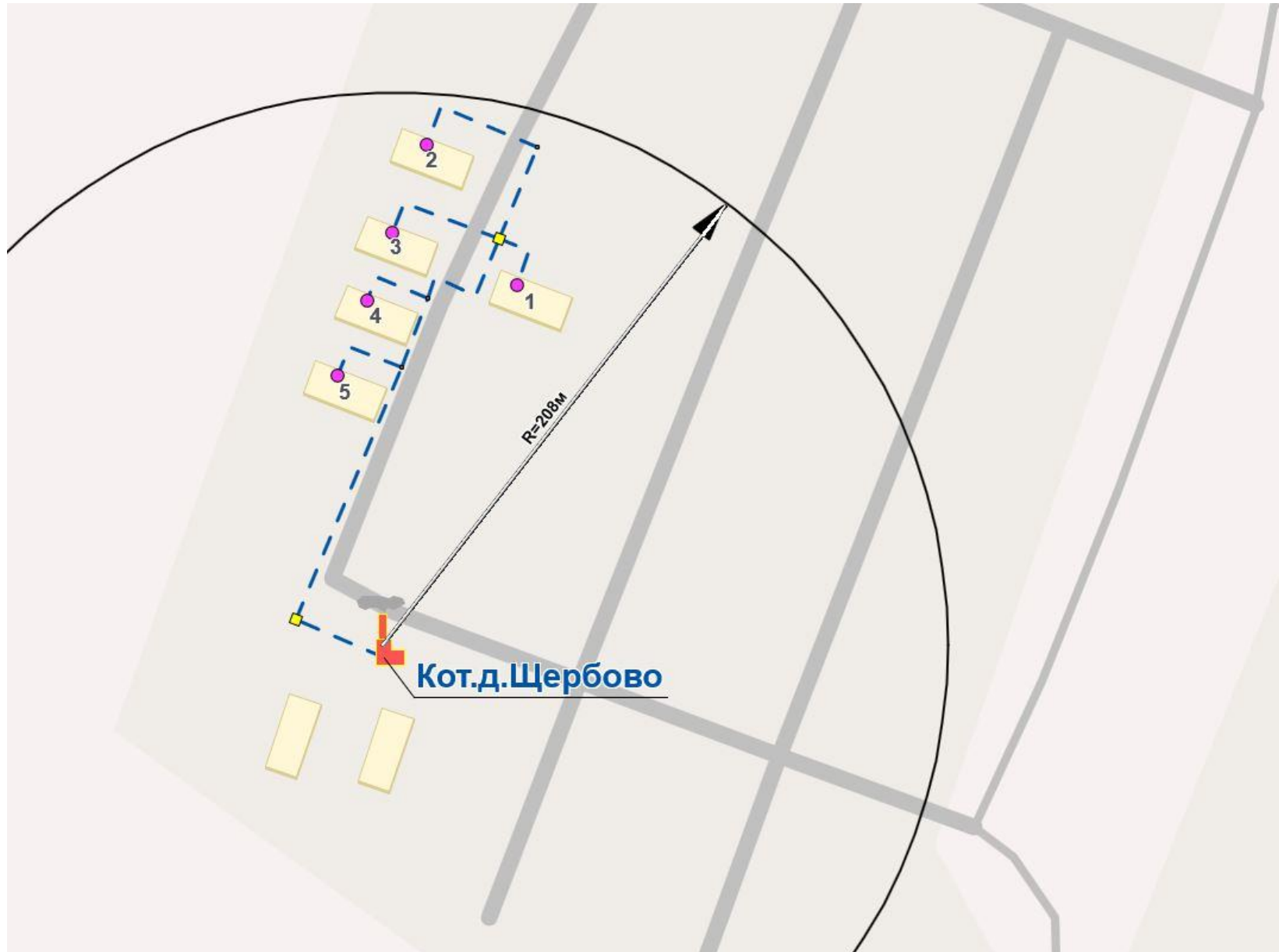
Рисунок 7 - Радиус эффективного теплоснабжения существующих источников тепловой энергии
